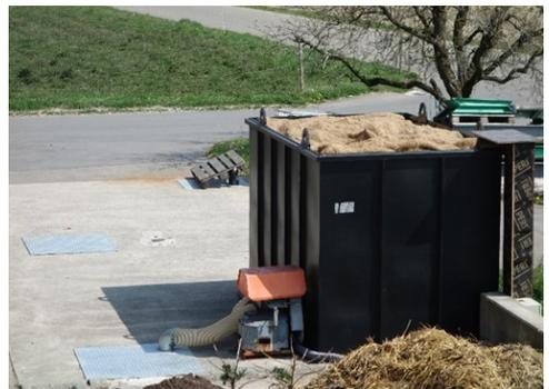
Die Abluft aus der Güllegrube wird mit einem Ventilator über eine Leitung abgesaugt und dem Biofilter zugeführt. Die abgesaugte Luftmenge ist um ein Mehrfaches höher als die Entlademenge.
