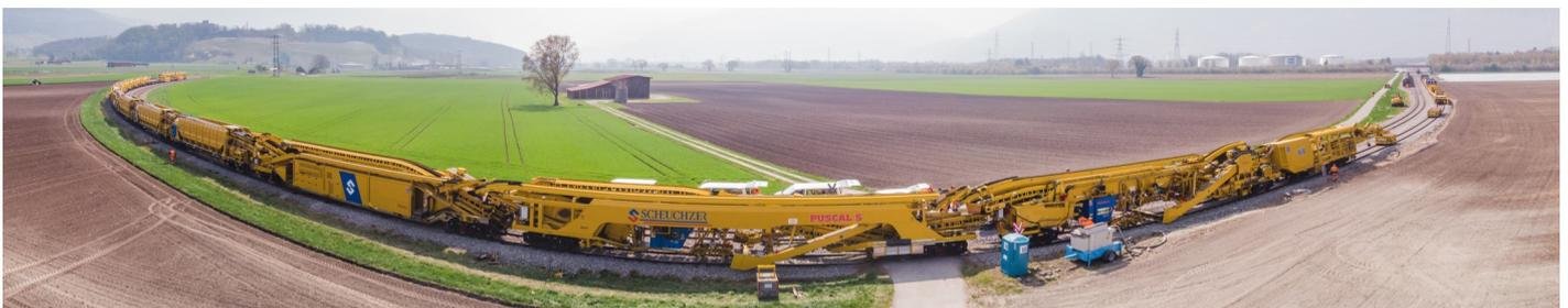
Umbauzug «Puscal S»: Mit dieser Gleisbaumaschine wird die Fahrbahn erneuert.
