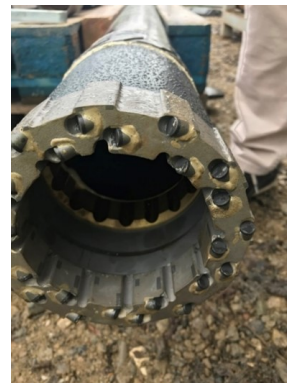
Mit dieser Bohrkronen wurden Gesteinsproben aus der Tiefe geholt
